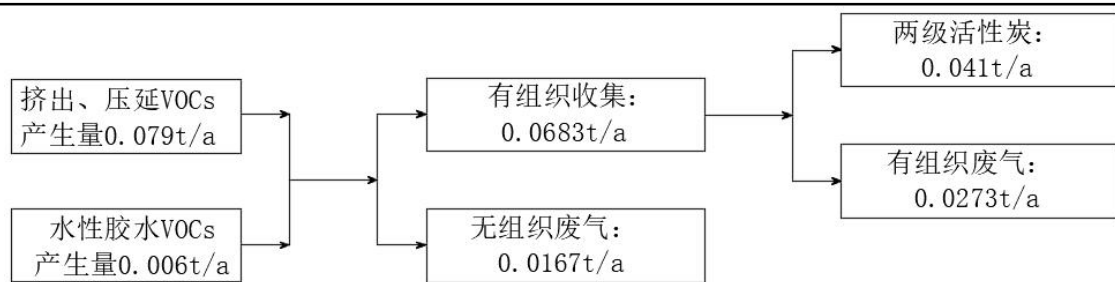
图 2-1 项目全厂 VOCs 平衡图 (单位: t/a)
